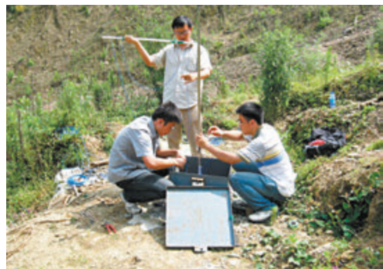
●2010年，朱鴻鵠（中）在汶川震區魏家溝布設泥石流傳感器，進行泥石流監測。受訪者供圖
