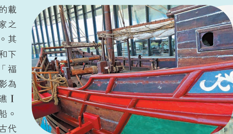
◆「華光礁 I 號」復原船使用了「魚鱗搭接」、「多重船板」、「水密隔艙」等建造工藝。
