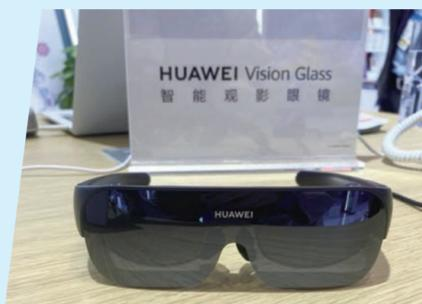
可在等效4米遠的虛擬空間中投射出120英寸巨幕，畫面清晰、色彩生動，還支持0到500度近視調節，廣東展館中最引人注目的當屬「科技感」十足的數字文化展廳，其中華為帶來了近日發布的首款智能觀影眼鏡——HUAWEI Vision Glass。這台眼鏡不僅支持與手機、平板、筆記本電腦等設備快速連接，也可以接入AITO汽車及超過100款接入了HUAWEI HiCar的車型。工作人員介紹，該眼鏡功耗較低，有線連接一台電池容量為4000mAh的手機後，可連續播放視頻4到5小時。
