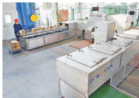
■ 首台冷鏈食品外包裝電子束消毒設備樣機啟動現場模擬實驗。
