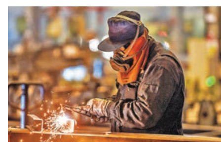
■ 特種車輛製造工人在焊接汽車配件。
