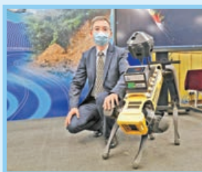
■機械狗可負載 14 公斤的器材，包括激光掃描器、攝影測量儀器等。
