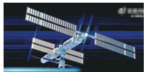
如模擬圖所示，對接完成後，問天艙太陽翼將二次展開，以建立完整的能源系統。
