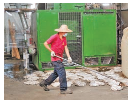
■膠箱經機器打碎，透過熱熔工序，將其壓縮成長條狀，並製成膠磚。
