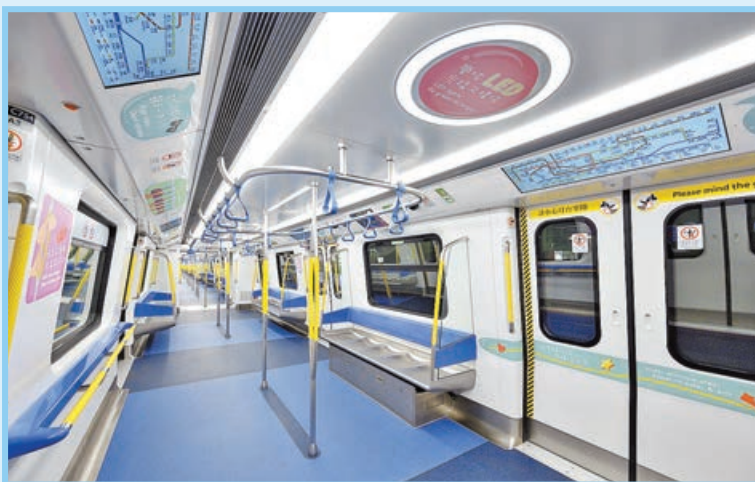
「Q-Train」全面採用「LED」照明系統，光線更柔和，車廂更明亮。
