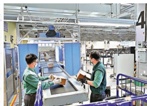
職員把郵包放在輸送帶上，系統便自動掃描郵包上的條碼、量度重量和尺寸。
