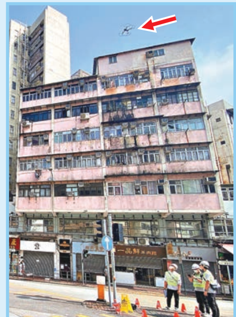
■屋宇署人員以無人機(箭嘴示)勘察有潛在風險較高的樓宇外牆。
