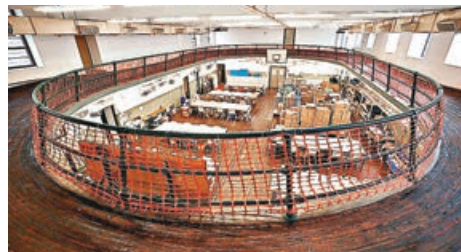
■香港中華基督教青年會大樓的體育館，以懸臂式結構支撐木製鑊形跑道。
