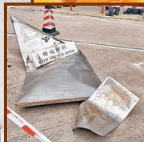
電錶房鋼門被炸至扭曲變形，飛出馬路中心。
