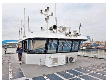
■渡輪甲板配備大量太陽能板。
