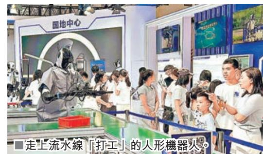
魔法原子公司首次線下展示了通用人形機器人「雙手操作」的工業流水線「點膠場景」。機器人可雙手同時完成兩個電機的點膠作業。「這是我們的全尺寸通用雙足人形機器人『小麥』，在去年底就已進入工廠實地『打工』了。它能夠實現連續超4小時不間斷作業，點膠動作精度穩定控制在1毫米至2毫米內。」魔法原子負責人說。
