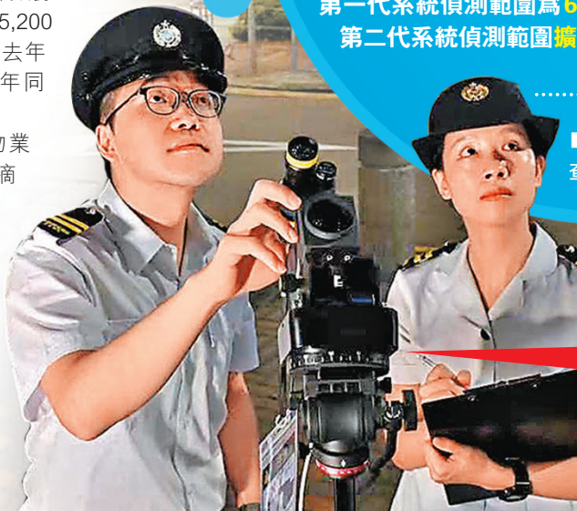
冷氣機滴水調查系統，配備紅外線夜視錄像功能。
