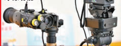
冷氣機滴水調查系統，配備紅外線夜視錄像功能。
