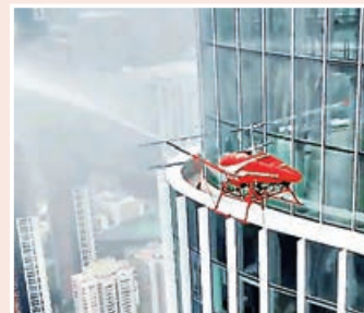
無人機在深圳羅湖區城建雲啟大廈，完成306米高空噴水測試。網上截圖
