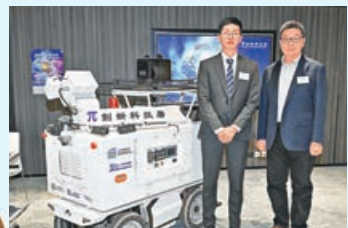
■ 香港生產力促進局參與研發的「地空協同隧道自動檢測系統」。
