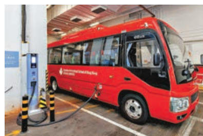
■校內裝有電動車快速充電設施。
