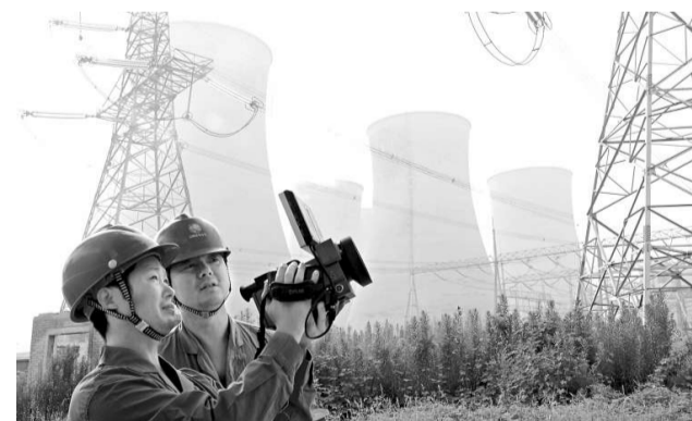
安徽淮南供電職工利用紅外線測溫儀對大唐洛河發電廠輸往華東電網線路進行監測，確保電網安全運行（新華社）
