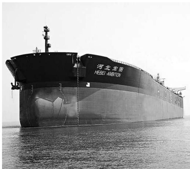
改造成功 河北遠洋運輸集團所屬的礦砂船「河北宏圖」輪改造成功，正式投入營運。該輪由VLCC改造為超大型礦砂船工程，於2007年11月在舟山中遠船務開工，經過10個月的時間順利完成改造，改造後載重為28.1539萬噸，是中國目前最大的礦砂船，首航開赴巴西運送鐵礦石。
