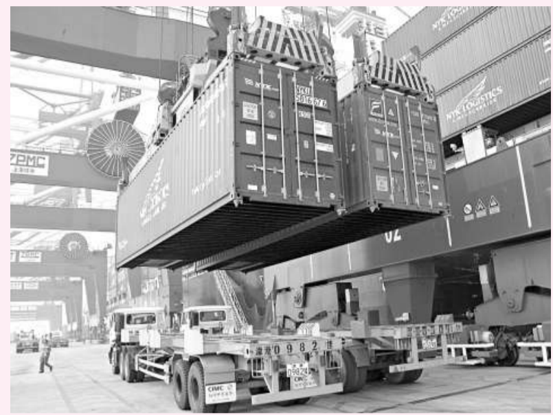
天津港採用先進工藝，實現「一鈎雙箱」作業
