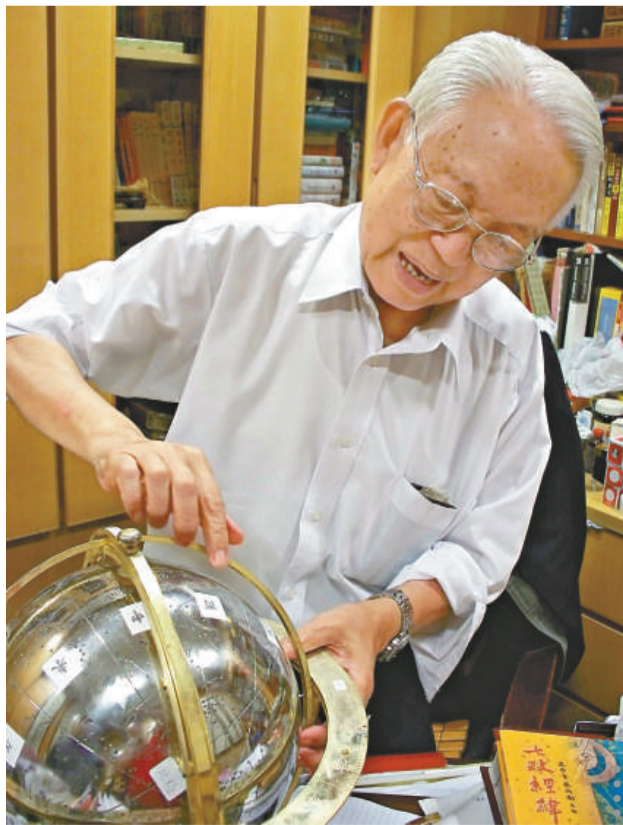
蔡伯勵乃「蔡真步堂」第三代傳人，近年便潛心重新鑄造其祖父蔡最白的渾天儀，去年初更將首個重鑄成功的渾天儀送給天文台台長林超英。蔡老師說：「渾天儀將「天球」分成為12瓣，即是共有12個宮，一宮佔30度，用12地支來代表，太陽到卯宮即是九月，到亥宮即是一月。」(官漢傑攝)
