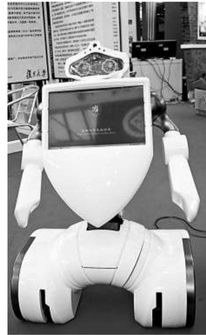
「復娃」的臉部能模擬包括「微笑」、「思考」等在內的多種表情，其頭部安裝的視覺及紅外感應系統，使其能知性避讓障礙物
