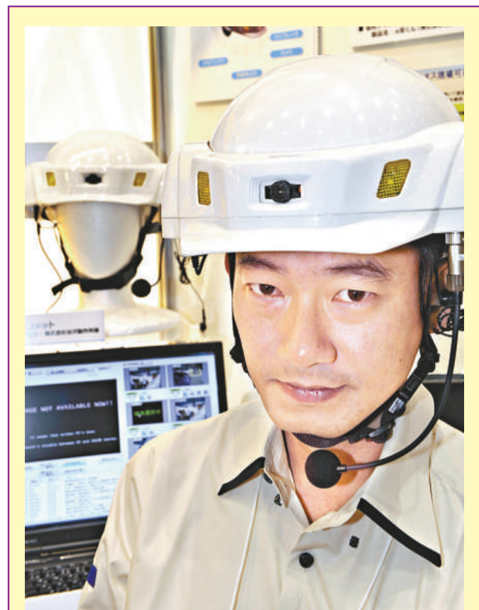
頭頂攝錄 日本電子品牌NEC展示一款高科技頭戴式攝影機「U-met」，集合了多功能的傳感器，例如攝影機、GPS追蹤設備、耳機，可透過無線LAN或3G移動電話網絡與外界作即時溝通。「U-met」的開發可為安全人員、消防員和急救隊員在突發事故現場作第一時間的記錄。（法新社）
