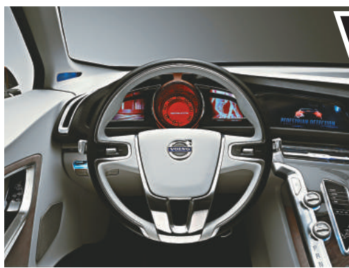
▲►Volvo S60備有自動煞車系統，當汽車快將撞向另一架車或行人的時候，不論行車速度快慢均會立即自動煞停
