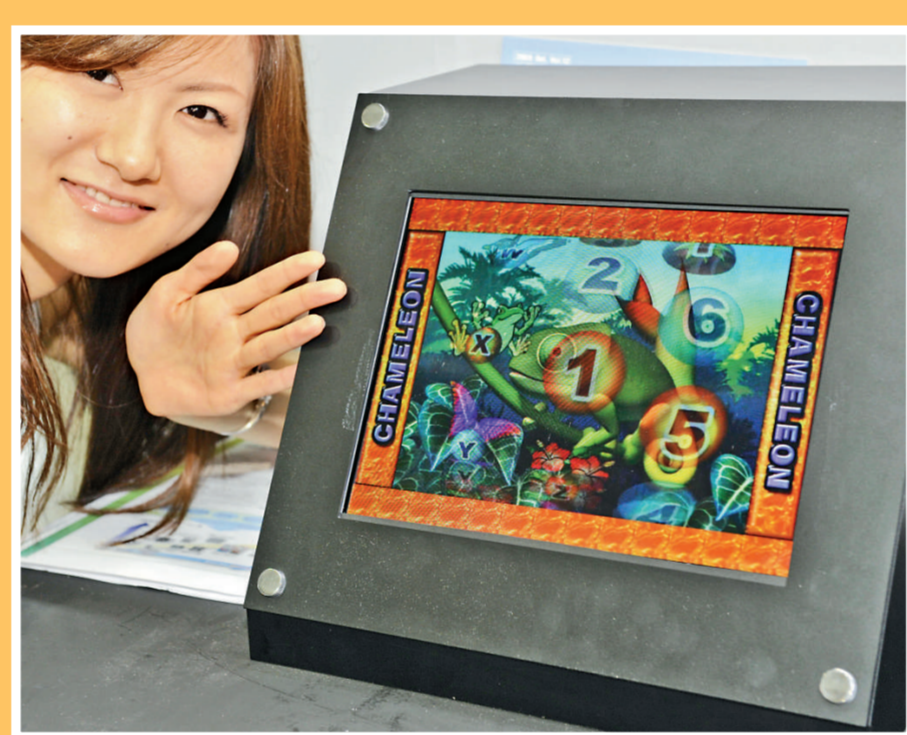
▲日本 NEC 展出一款十二點一吋的 3D 立體平板 LCD 顯示器。這款顯示器採用了立體顯示用像素排列「HDDP」方法 (Horizontally Double-Density Pixels)，可以把影像輕易轉變成 2D (平面) 或 3D (立體)。
