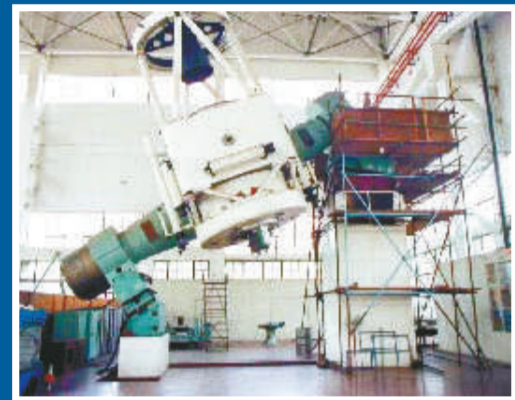
▲▲安裝在國家天文台興隆觀測站、遠東最大口徑2.16米天文光學望遠鏡,可進行照相、光電、光譜觀測(網絡圖片)
