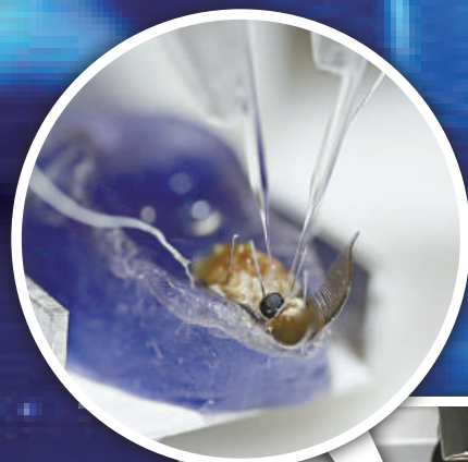
◀▼雄蛾的腦部與車連接，在沒有翅膀或腳的情況下，雄蛾竟能「駕駛」玩具車移向目標（法新社）
