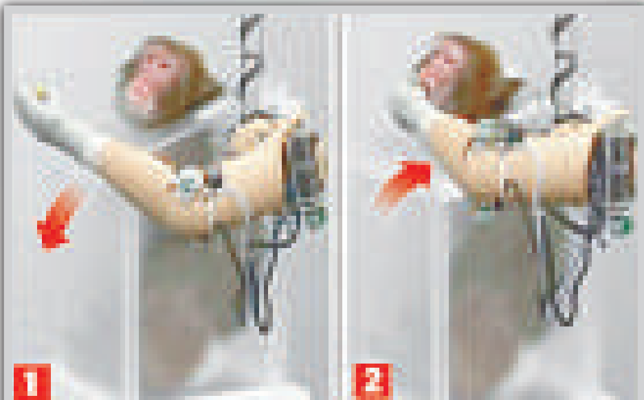
1 食物放在猴子面前，牠想拾起食物時，機械臂的感應晶片接收到牠的腦神經細胞發出的電流訊號，把其傳送到控制機械臂的電腦。
