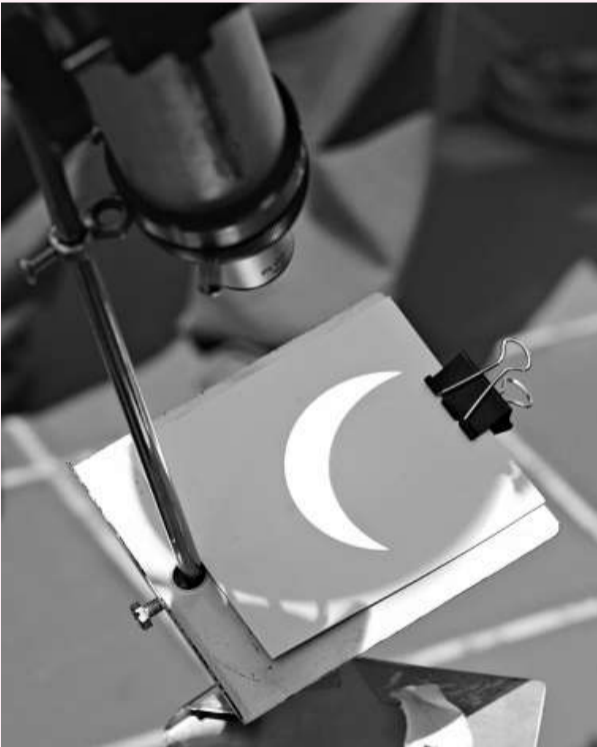
台灣嘉義地區因天氣穩定，觀測條件良好，北回歸線太陽館利用折射式望遠鏡，將日食景象投射到觀測板上
