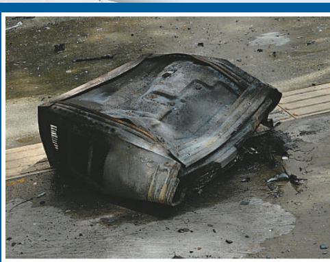
電視機出現短路後燒着雜物，單位內冷氣機被燒熔整部飛落街
