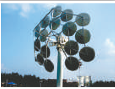
▲定日鏡是塔式太陽能發電電站的關鍵部件之一 ▼中科院電工所研製的多碟式聚光器
