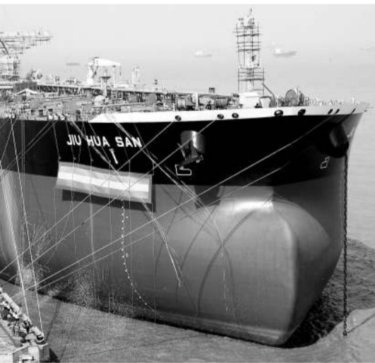
外高橋造船公司為新加坡海洋油船公司建造的綠色環保型31.9萬載重噸超級油輪「九華山」號
