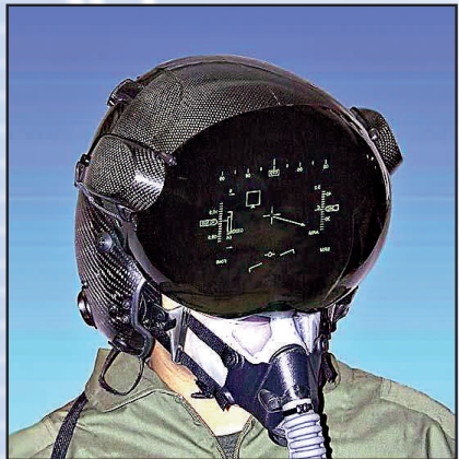
F-35 將是世界上首次使用虛擬頭盔顯示器的戰鬥機，安裝在頭盔上的顯示裝置直接把畫面投射在飛行員的面罩上
