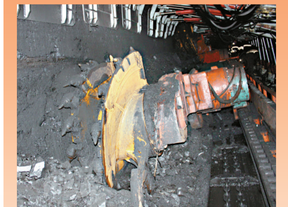
採煤機正在井下煤層進行機械化採煤
