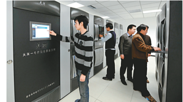
我國第一台千萬億次超級計算機系統——「天河一號」一期機櫃設備，在天津濱海新區完成系統安裝，目前已進入系統調試階段，二〇一〇年元旦後正式投入運營。圖為二十五日，技術人員對「天河一號」系統進行測試。（新華社）
