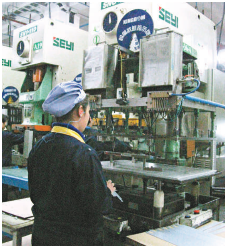
金德精密五金有限公司為二十二台衝壓機安裝節電器，每年可節省用電量達39%
