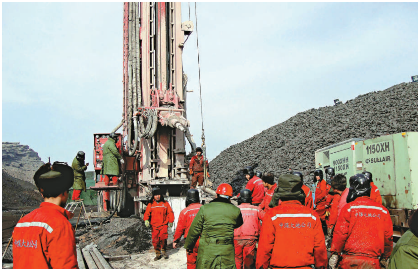
6日下午，參與搶險救援的中國煤炭地質總局大地技術勘測公司的鑽機，打通了第二個鑽孔，使井下巷道形成空氣回路 (新華社)
