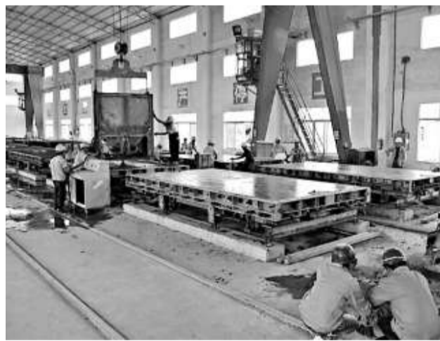
專用於獅子洋隧道的「CRTS-I型預應力混凝土板式無砟軌道板」近日正式投產，今年十月底前完成鋪軌
