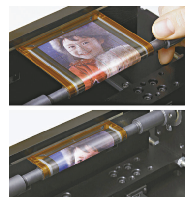
▲索尼新研發的超薄的捲曲顯示屏，可望用於手機、電視及電子報紙等產品 法新社
