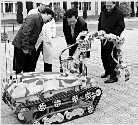
▲中國自主研製完成第二代排爆機器人「雪豹-10」 中新社
