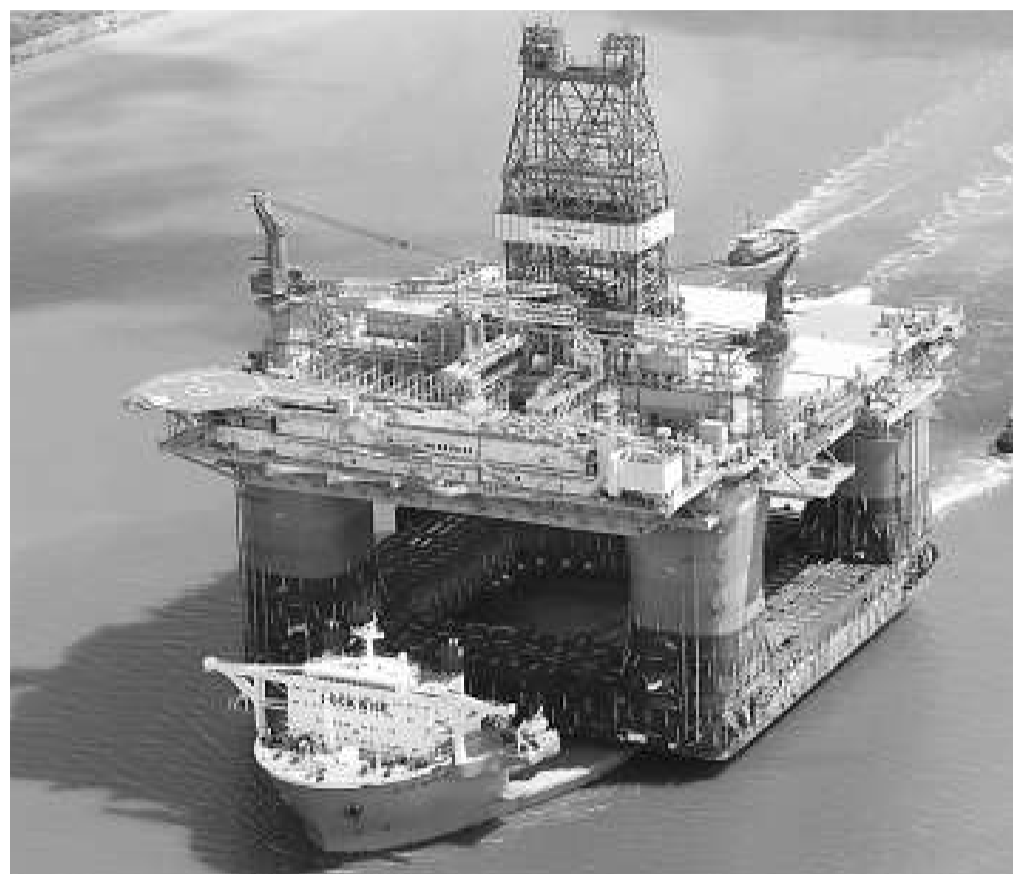
巨型鑽井平台被半潛式重吊船舉起，再運往目的地，這種特種運輸市場，目前仍由歐洲公司壟斷
