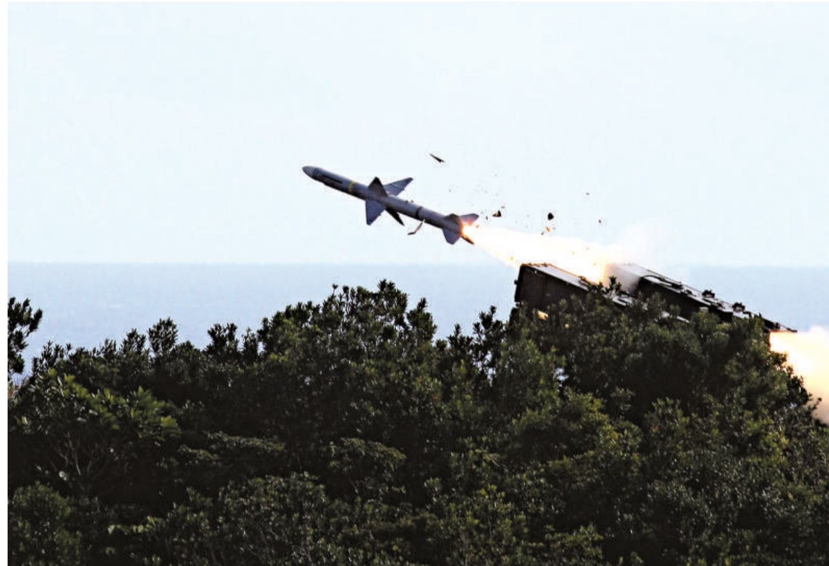
▲屏東九鵬基地18日舉行「聯合防空火力實彈射擊測考」，麻雀飛彈疑因推進器燃燒不完全，脫靶墜海 中央社
