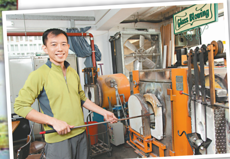
琉璃坊設有專門用來燒製玻璃的熔爐，溫度高達攝氏1200度，透過金屬管燃燒玻璃膏，最後可轉化為一粒粒晶瑩剔透的玻璃珠
