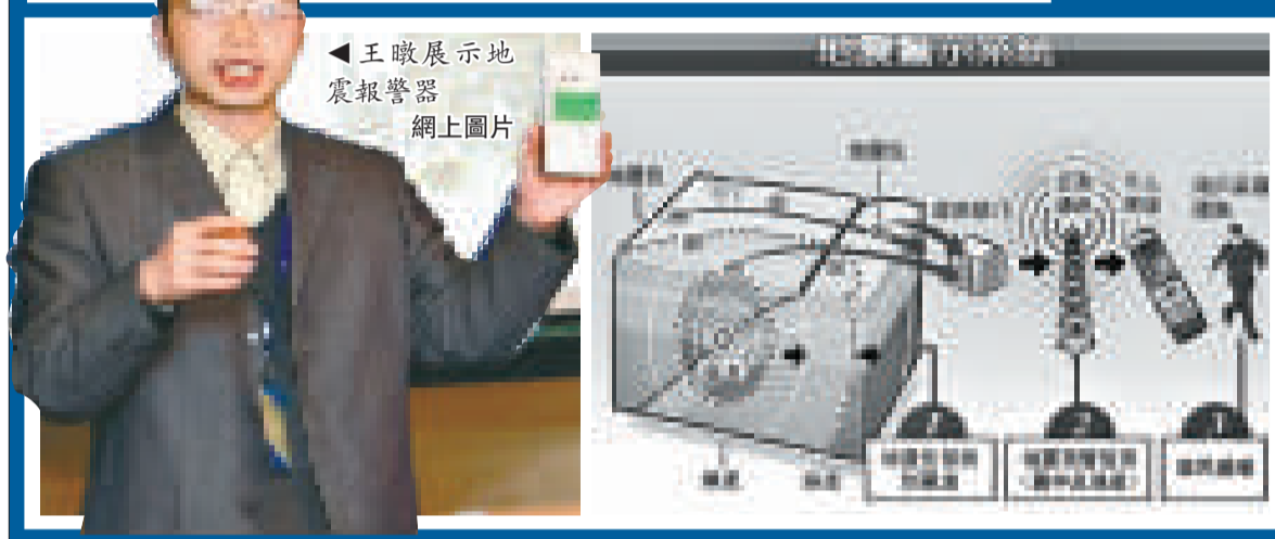
成都高新減災研究所研發的地震預警系統，能在地震波到達前十秒示警 網上圖片
