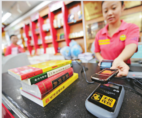
▲「無線蘭州」城市一卡通5日試運行，使用者可通過該系統在同一張手機SIM卡或CPU單卡中內置數字證書、手機錢包、公交卡、企業卡、校訊通等多個應用，實現電子刷卡消費和企業、校園的門禁、考勤、內部支付等
