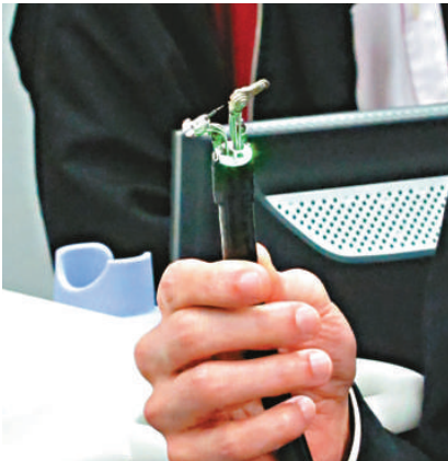
◀機器人內鏡平台以蟹爪為概念，將微型的機械臂結合內鏡，處理複雜的微創手術 本報記者李家祺攝
