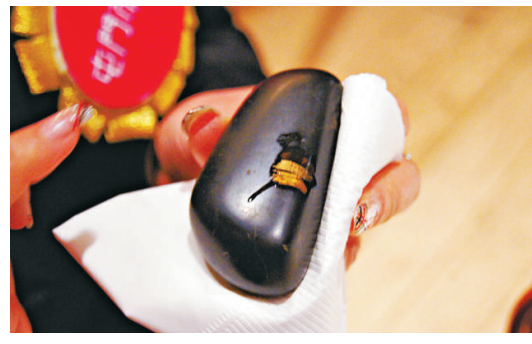
▲不同成色的金在試金石上顏色不同，藥水作用下成色差的黃金顏色會消失
