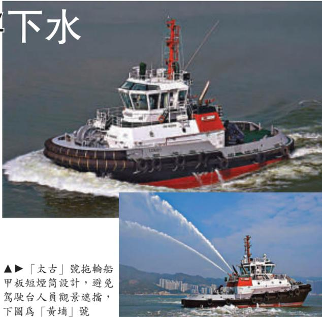
▲▲「太古」號拖輪船甲板短煙筒設計，避免駕駛台人員觀景遮擋，下圖為「黃埔」號
