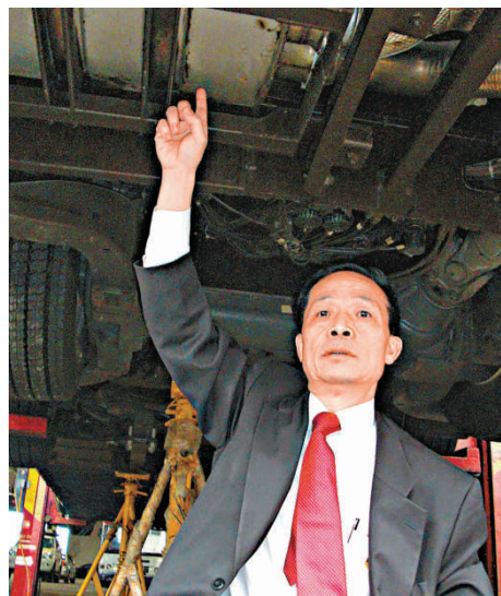
▲沈乙紅指歐盟第五代環保巴士選擇性催化還原器能夠令巴士引擎排放氮氧化物大幅減少
